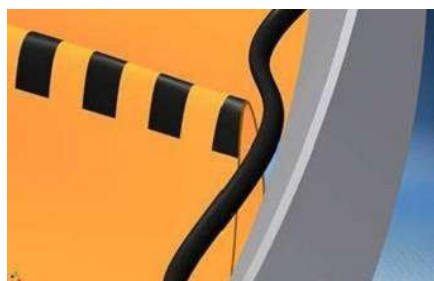
Figure 13 : Modélisation de la zone de pincement des anguilles, entre les pales de la roue et le manteau de la turbine (MJ2 Technologies, 2009).
