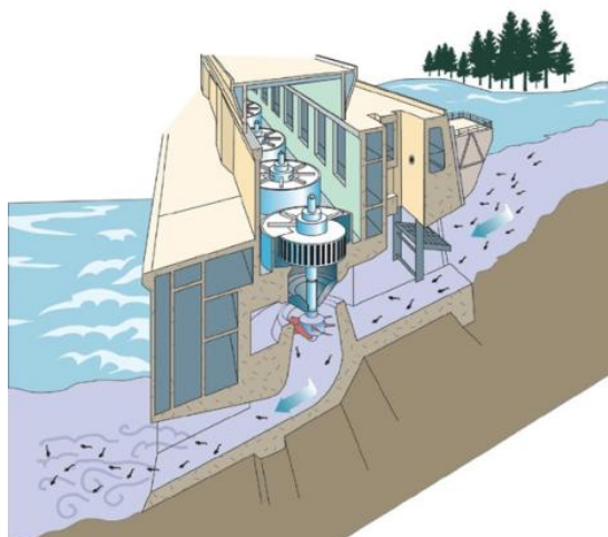
Figure 4 : Section simplifiée d'une installation hydroélectrique typique montrant la prise d'eau, la turbine (type Kaplan), les conduites et le flux de sortie. Les poissons entrent dans la turbine et traversent ses composants lors de leur dévalaison.
