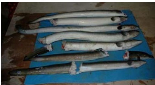
Figure 11 : Les 7 anguilles du groupe "gros individus" sectionnées après avoir traversé la turbine VLH par sa périphérie. Source : ECOGEA (Lagarrigue, Voegtle, & Lascaux, 2008).
