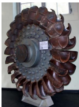
Figure 1 : Turbine Pelton de la centrale hydroélectrique de Walchensee en Allemagne. Source : Wikipedia.fr
