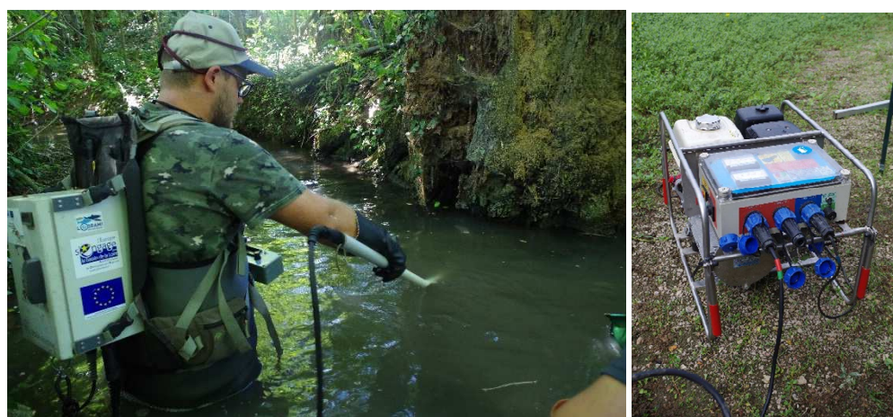
Figure 11 : Matériel utilisé pour l'échantillonnage : portable (à gauche) et fixe (à droite).
