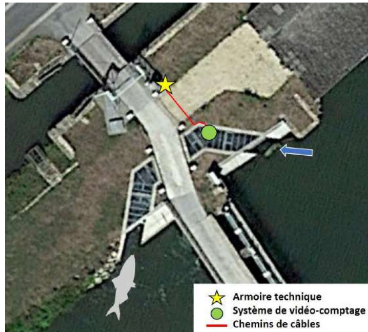
Figure 2 : Localisation du dispositif de vidéo-comptage installé dans la passe à poissons du barrage de la Sotterie sur la Sèvre Niortaise (image Google Earth)
