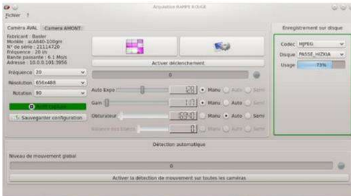
Figure 5 : Fenêtre de réglages des caméras (exposition, vitesse, ...)
