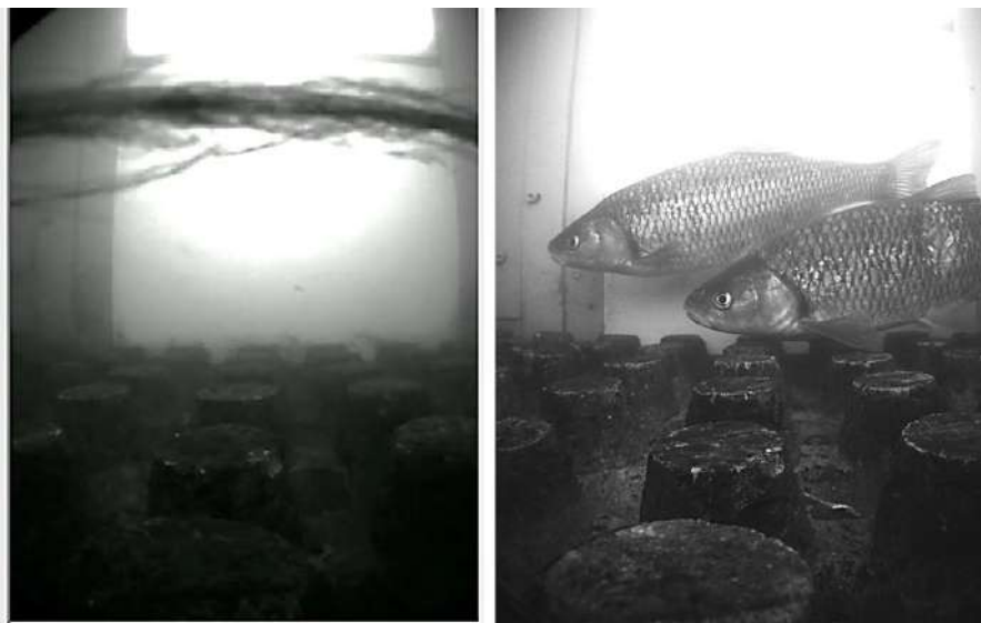
Figure 11 : Captures d’écran illustrant les principaux éléments responsables des sur-déclenchements
