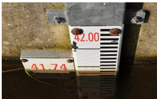
Figure 14 : Mire graduée sur laquelle la côte du plan d'eau à respecter est indiquée par un trait rouge
