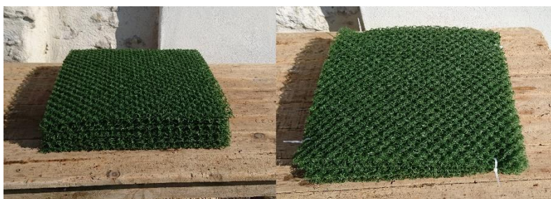
Figure 6 : Dix couches de géotextile superposées (gauche) puis reliées entre elles (droite). Photos : A. Chenal
