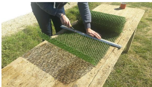
Figure 5 : Découpage du géotextile en carrés de 50 × 50 cm. Photo : J.-G. Robin
