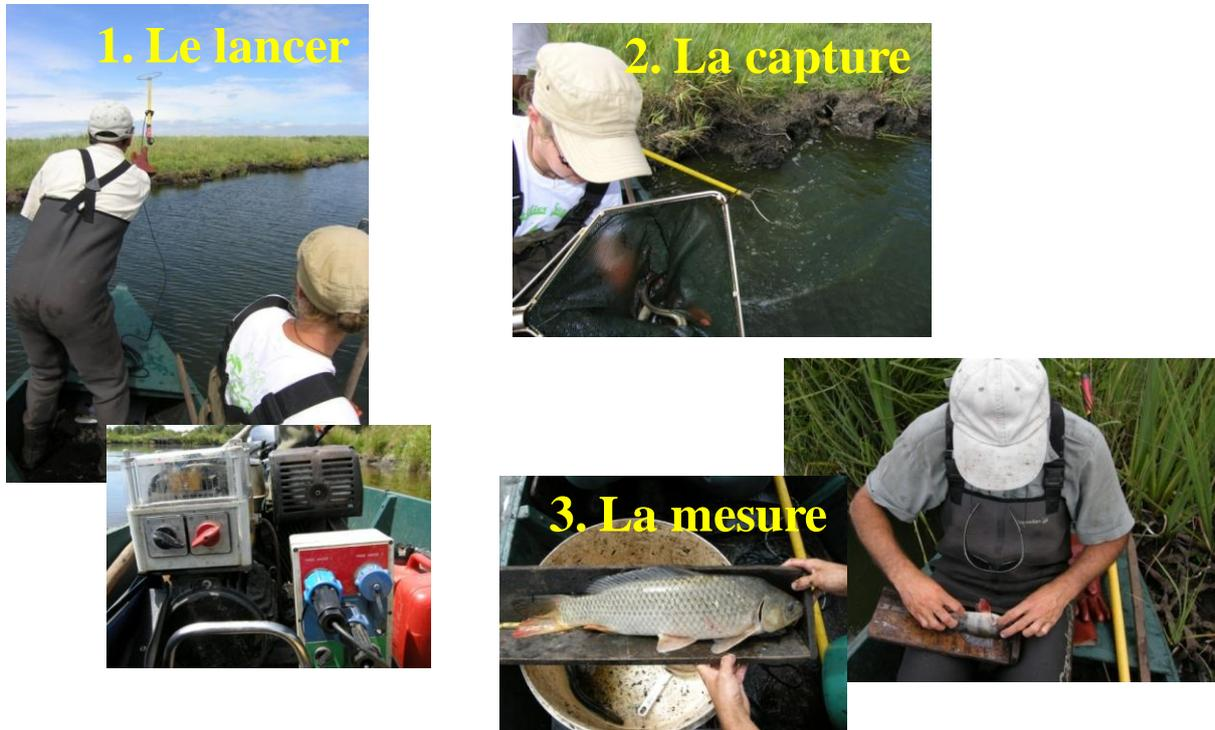
**Photographie 1.** Séance de pêche électrique dans un canal des marais du Brivet : (1) lancer d'anode, (2) capture des poissons tétanisés et (3) identification et mesure des poissons avant remise à l'eau.
